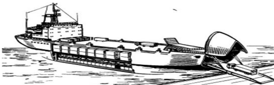
Рис 16. Схема судна с горизонтальным способом грузообработки.
